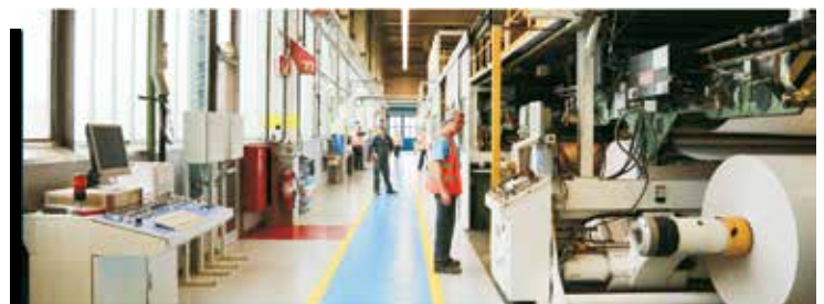
WPA (Wellpappenanlage) für die Herstellung Wellkarton.
