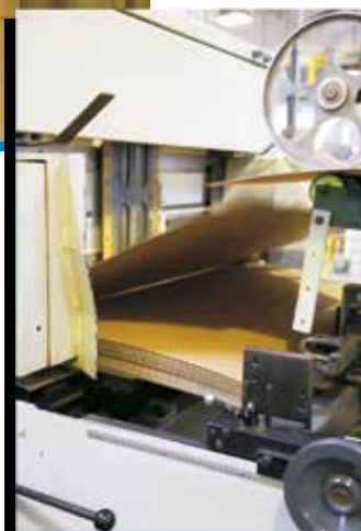
Einzug der Wellkartonbögen in einen Stanzautomaten.
