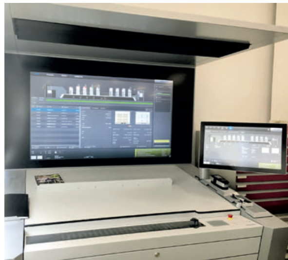
Kontroll- und Steuerpult «PressCenter 3»
